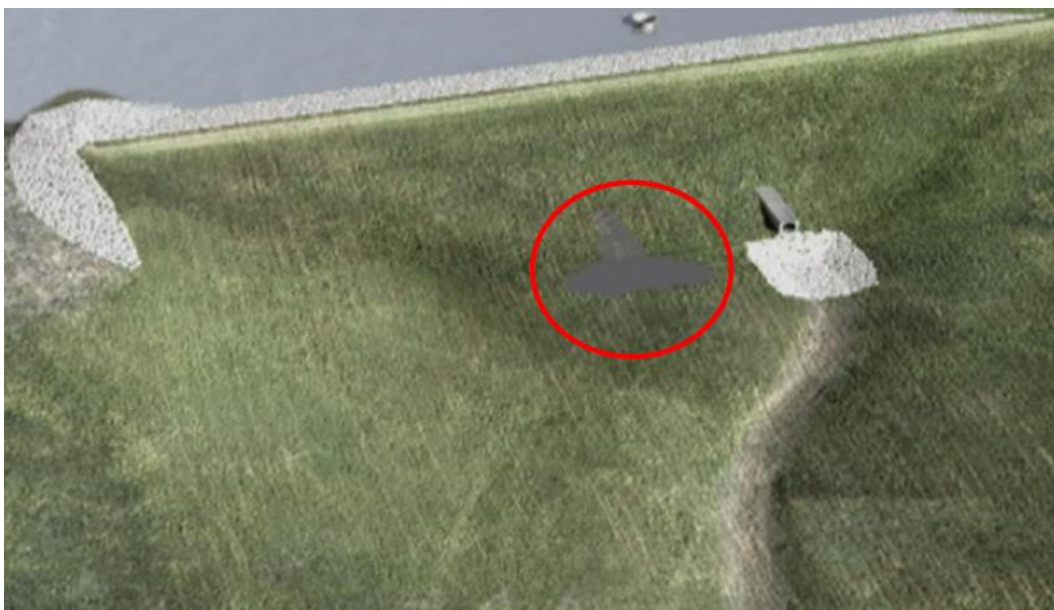
Figura 5-1 – Simulação de surgência observada no talude de jusante.
